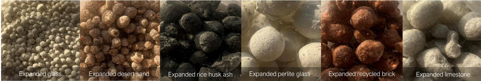
Die **Expansionstechnologie und -prozesse** von Beton ermöglichen die Herstellung und Einsatz von lokal bezogenen, billigen, expandierten und leichten Aggregaten.
